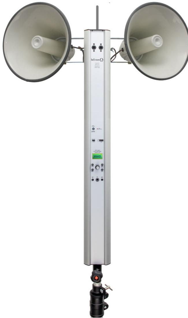
Sistema processionale in alluminio anodizzato con amplificatore digitale e radiomicrofono professionale UHF 16 canali. Elevata autonomia fino a 6h con batterie ricaricabili al Ni-Mh da 4.5Ah. Porta USB per file MP3. Possibilità di sostituire le trombe con 02 diffusori a colonna per una ancora maggiore eccellente qualità timbrica.
